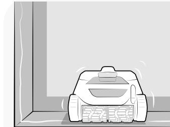
**1** De app stuurt een waarschuwing aan het einde van de cyclus (uitgezonderd "Alleen vloer"): vanaf dit moment, wacht de robot 30 seconden aan de bovenkant van elke muur (de een na de ander) gedurende 10 minuten.
