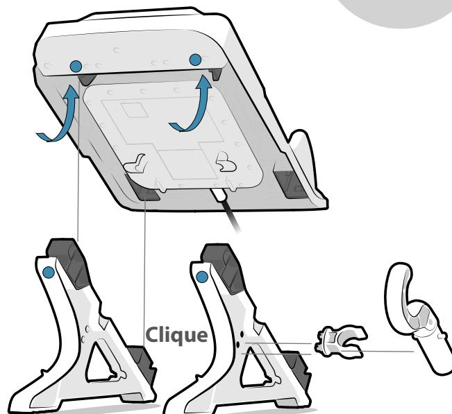
1 Deslize o topo do pé (círculo azul) sob a base da estação (círculo azul), e encaixe a parte inferior do pé.
