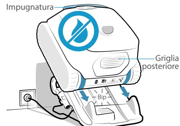
1 Far asciugare il robot prima di metterlo in carica.
