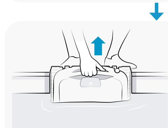
**2** Sortir complètement le robot de l'eau en utilisant la poignée.
